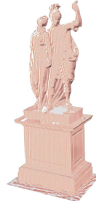
**EINE PUNKTEWOLKE** ist ein Datensatz, der die Oberfläche eines gescannten Objektes wieder spiegelt. Sie wird durch eine Reihe von Messpunkten, die vom Scanner aufgenommen worden sind, als 3D Bild wiedergegeben.
